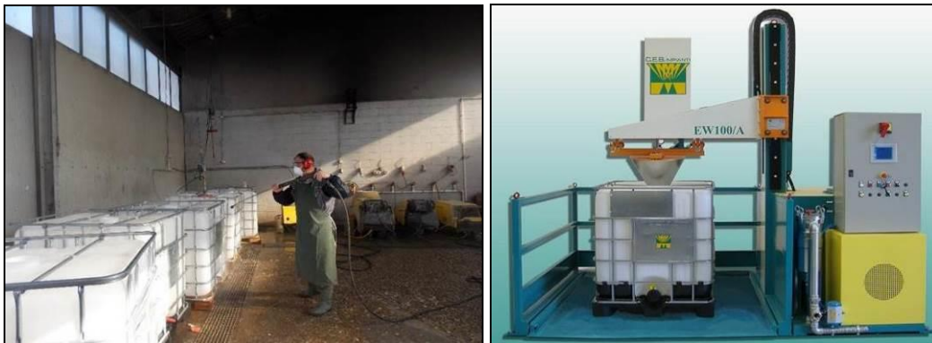
Slika 5.– Manuelno pranje (levo) i automatski uređaj za pranje (desno)
