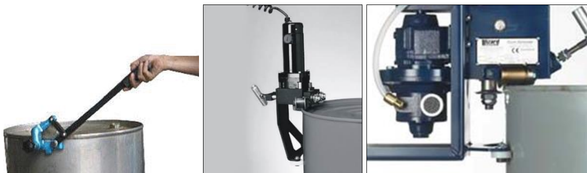
Slika 4. - Ručni otvarač bačvi (levo) jednostavniji otvarač na električni pogon (u sredini) i preporučena mašina za kružno odsecanje gornjeg dela bačve (desno)
