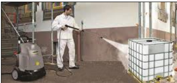
Spoljašnje pranje IBC kontejnera mašinom za pranje toplom vodom pod pritiskom
